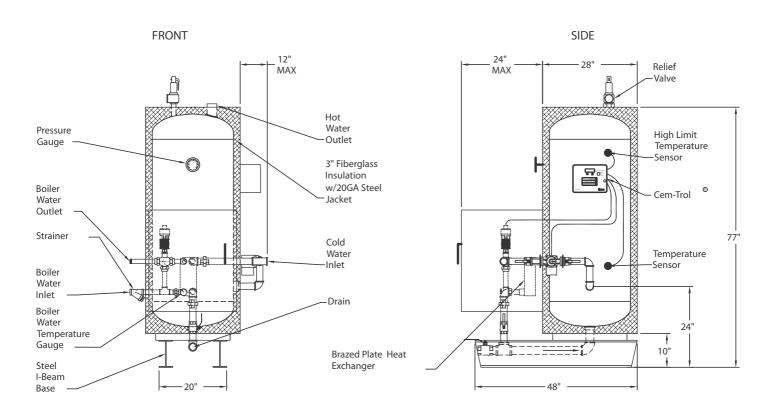
V120SPH-BP-3W BRAZED PLATE HEAT EXCHANGER
