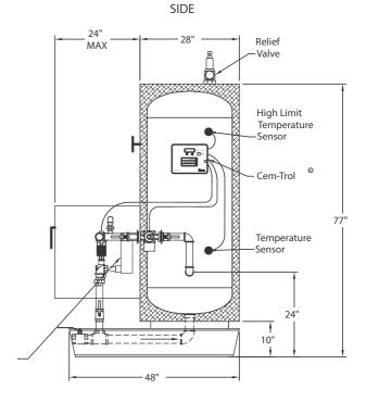
V120SPH-BP-2W BRAZED PLATE HEAT EXCHANGER
